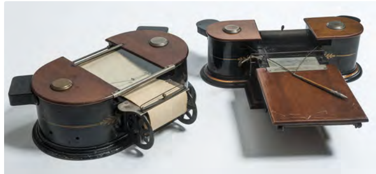
Der »Telautograph« (1893) von Elisha Gray: Der Geber (rechts) wandelt mechanische Schreibbewegungen in elektrische Ströme um. Im entfernten Empfänger (links) betätigen sie ein mechanisches Schreibwerk, das die Nachricht »fernkopiert«.
